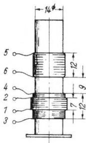
Links: Bild 5. Konstruktionsbeispiel eines Zf-Bandfilters für die Röhre EQ 80. Abschirmbecher 30 mm Ø, 60 mm hoch; L = 3,85 μH; Wicklung 1,2 = 20 Windungen Cu L 0,3 Ø; Wicklungen 3,4 und 5,6 = 20 Windungen Cu L 0,55 Ø
