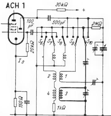
Bild 1. Fehlerhafte Wellenschalterstellung
