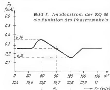
genau auf 10,7 MHz. Der Kreis C<sub>2</sub>, L<sub>2</sub> wird auf Maximalausschlag des Strommessers abgeglichen. Danach verstimmt man C<sub>2</sub>, L<sub>2</sub> und gleicht C<sub>1</sub>, L<sub>1</sub> in derselben Weise ab. Es ist zweckmäßig, bei diesen Maßnahmen die Kreisspannungen etwas kleiner zu wählen, um ein scharfes Maximum zu erhalten. Hat man das Filter richtig abgeglichen, so werden die Spannungen wieder auf den obigen Wert erhöht.
