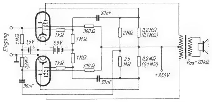
Schaltbild einer Nf-Stufe mit 2 x ECL 113 im Gegentakt-B-Betrieb mit fester Gittervorspannung; Triodenteile in Phasenumkehrschaltung
