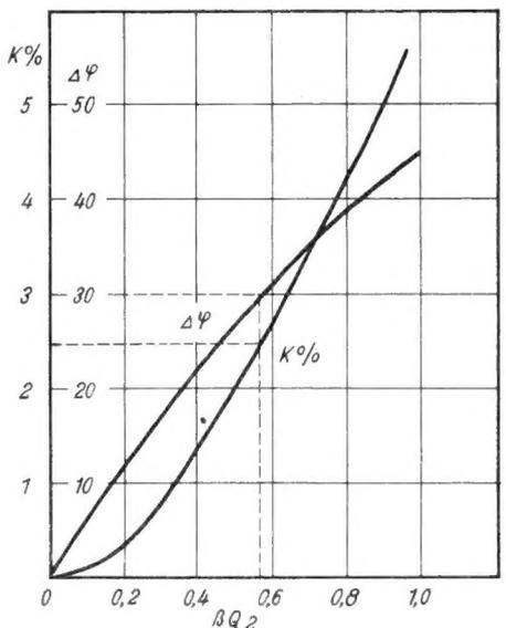
Bild 3. Abweichung  $\Delta \varphi$  des Phasenwinkels φ zwischen Bandfilter-Primär- und Sekundärspannung von dem in Bandmitte auftretenden Wert  $\varphi = 90^\circ$  und aus der Krümmung der  $\Delta \varphi$ -Kurve herrührender Klirrfaktor  $k$  in Abhängigkeit von dem normierten Frequenzhub  $\beta Q_2$
