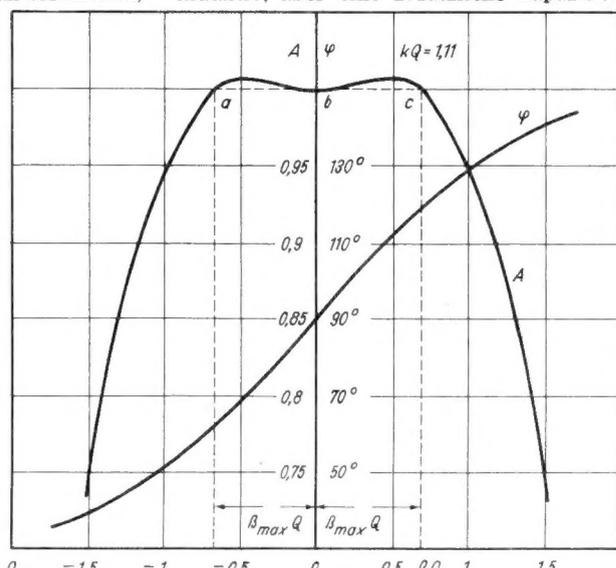
Bild 2. Amplitude A der Sekundärspannung und Phase φ zwischen Primär- und Sekundärspannung eines leicht überkritisch gekoppelten Bandfilters in Abhängigkeit von der normierten Verstimmung  $\beta Q$ . ( $\beta = \frac{2 \Delta f}{f_0}$ )
