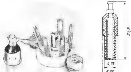
Überbrückungskondensator neben einer Röhrenfassung und im Schnitt
