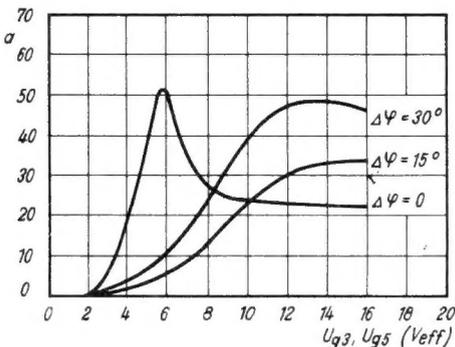
Bild 4. AM-Unterdrückungsfaktor a für verschiedene Beträge von Δφ in Abhängigkeit von der Zf-Spannung an den Gittern 3 und 5 der Röhre EQ 80
