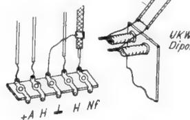
Rechts oben: Anschlußschema für nachträglichen Einbau eines UKW-Einbaugerätes
