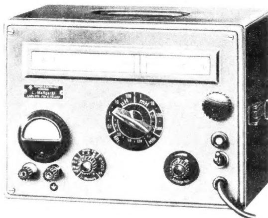
Selbstinduktionsmeßbereich ..... 0,1  $\mu$ H ... 1 H
